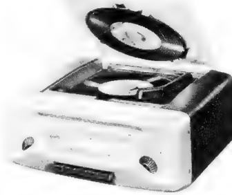
Ein sparsamer Permanentfeldmotor (Leistungsaufnahme  $4 \text{ V} / 20 \text{ mA} = 0,08 \text{ Watt}$ ) treibt über Reibrad den Plattenteller mit Schwunzmasse an, diese, sowie eine elektrische Drehzahlregelung, sichern Konstanz der Tourenzahl. Für die Stromversorgung werden neben dem Wechselstromnetzteil 117...220 V benötigt: 90-Volt-Anodenbatterie, drei Babyzellen für den Motor und zwei Monozellen für die Heizung.
