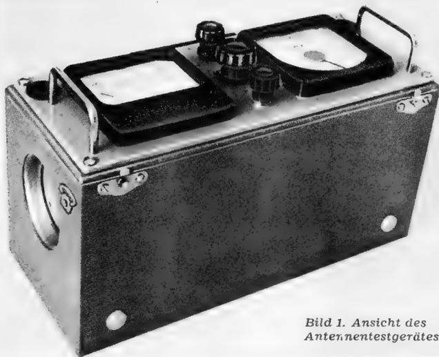
Bild 1. Ansicht des Antennentestgerätes
